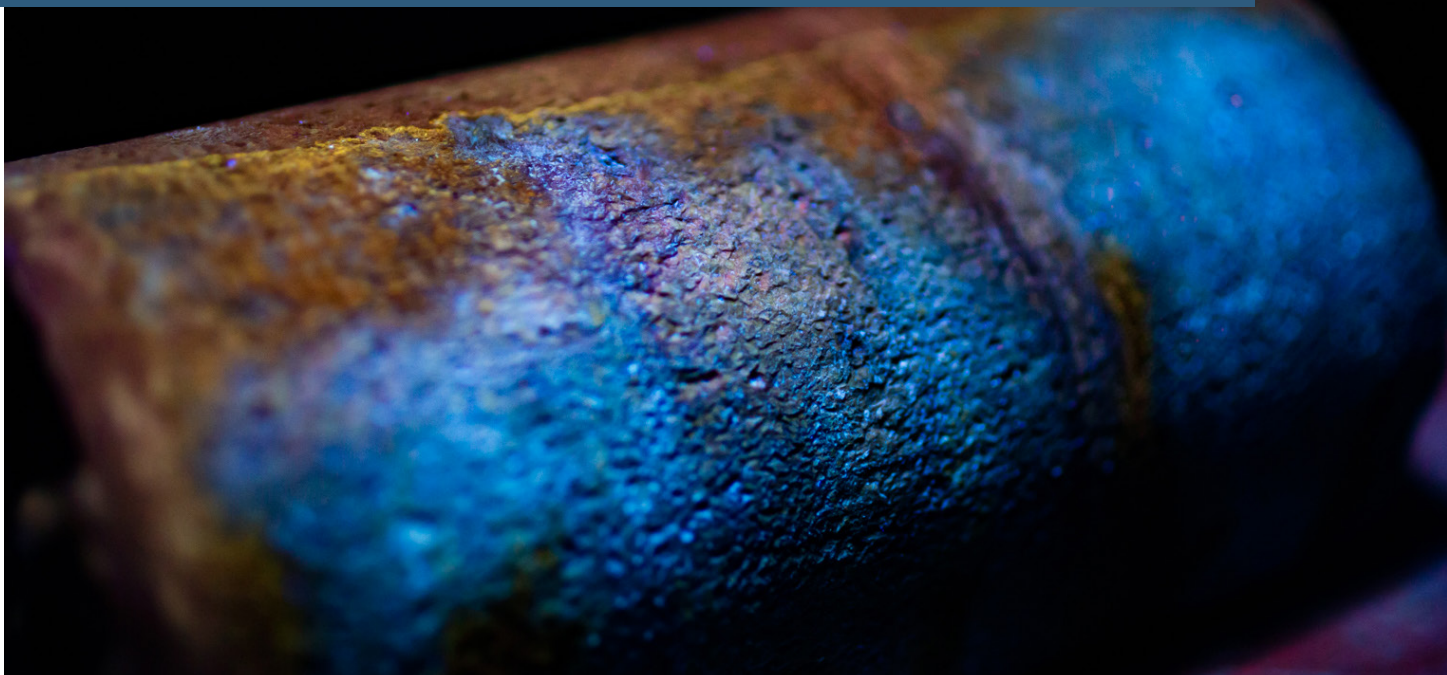
Photo : Carotte de la rivière Rouge avec tache d'huile sous lumière UV. Source : Saskatchewan Ministry of Energy and Resources
